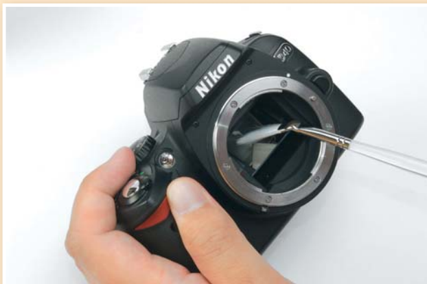
Con il pennello dedicato, inclinato di 45 gradi, si procede alla rimozione della polvere dallo specchio.
