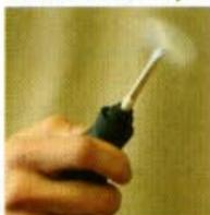
2 - On introduit le pinceau dans la chambre en prenant soin de ne pas toucher les parois (on risquerait de graisser les fibres) et on le positionne à une extrémité du capteur.
