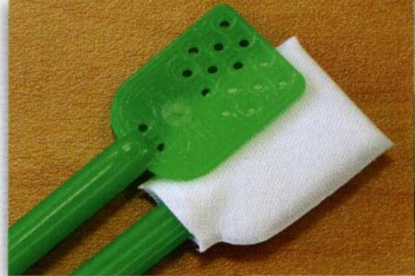
• Le textile est scellé de chaque côté de la spatule au lieu d'être maintenu par un élastique. Les bâtonnets VisibleDust existe également en trois dimensions pour s'adapter aux différentes tailles de capteurs (tableau des compatibilités sur [www.visibledust.com/help\\_sensorchart.php](http://www.visibledust.com/help_sensorchart.php)).
